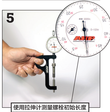
5 使用拉伸计测量螺栓初始长度
